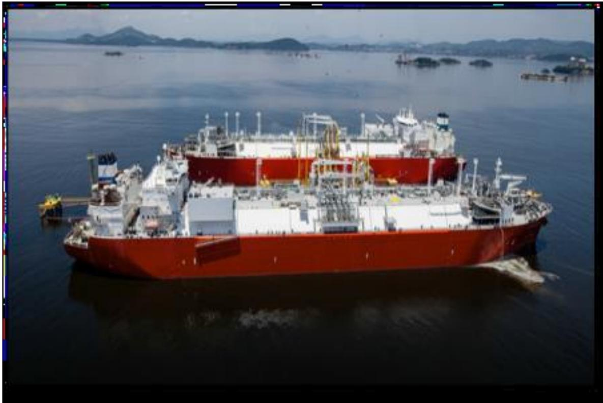
液化天然ガスの輸入、貯蔵、再ガス化を可能にし、2020年にはマリアグレタ火力発電所に300 MW の天然ガスを供給するため
